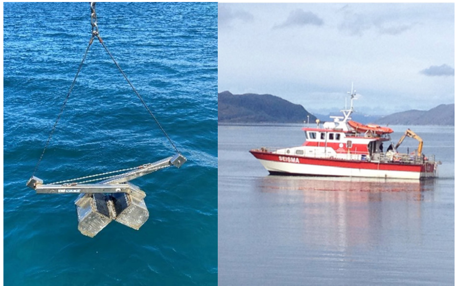
Seisma på feltarbeid i Repparfjorden (til venstre). Van Veen-grabb som ble benyttet til prøvetaking av sediment og bunndyr (til høyre).
